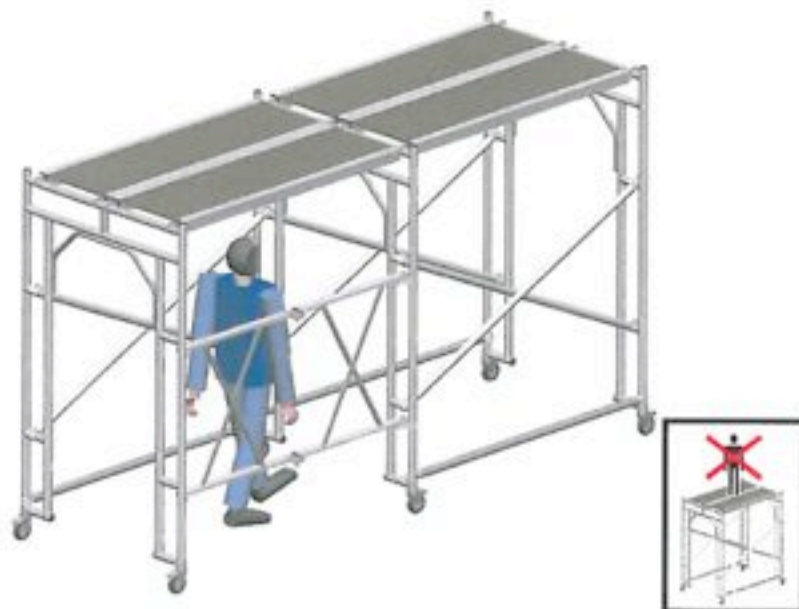
Esempio di configurazione del Passaggio protetto doppio.
